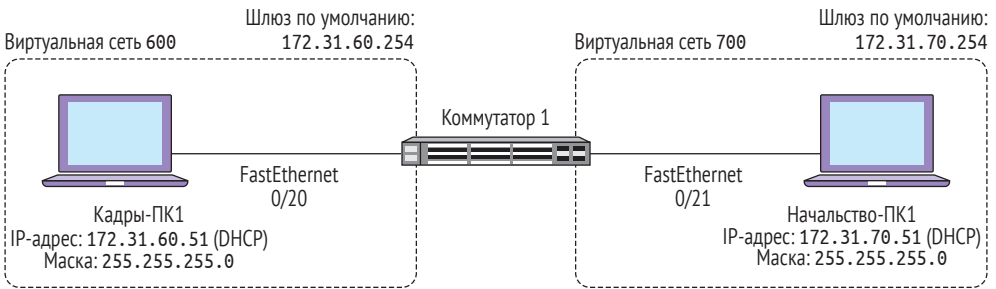
Рис. 9.1 ❖ Компьютеры Кадры-ПК1 и Начальство-ПК1 с назначенными DHCP-сервером IP-адресами
